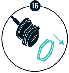
**16** Schraube die äußere der beiden Plastikmuttern von der Micro-USB Buchse ab. Die andere Mutter bleibt an der Buchse.
