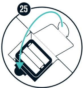
**25** Lege drei Batterien oder Akkus der Größe AA in den Batteriehalter. Lege den Batteriehalter ins Batteriefach und verschliese es.
